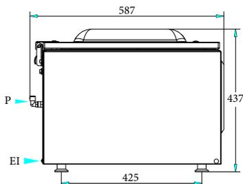
EI = Conexión eléctrica (energía)
